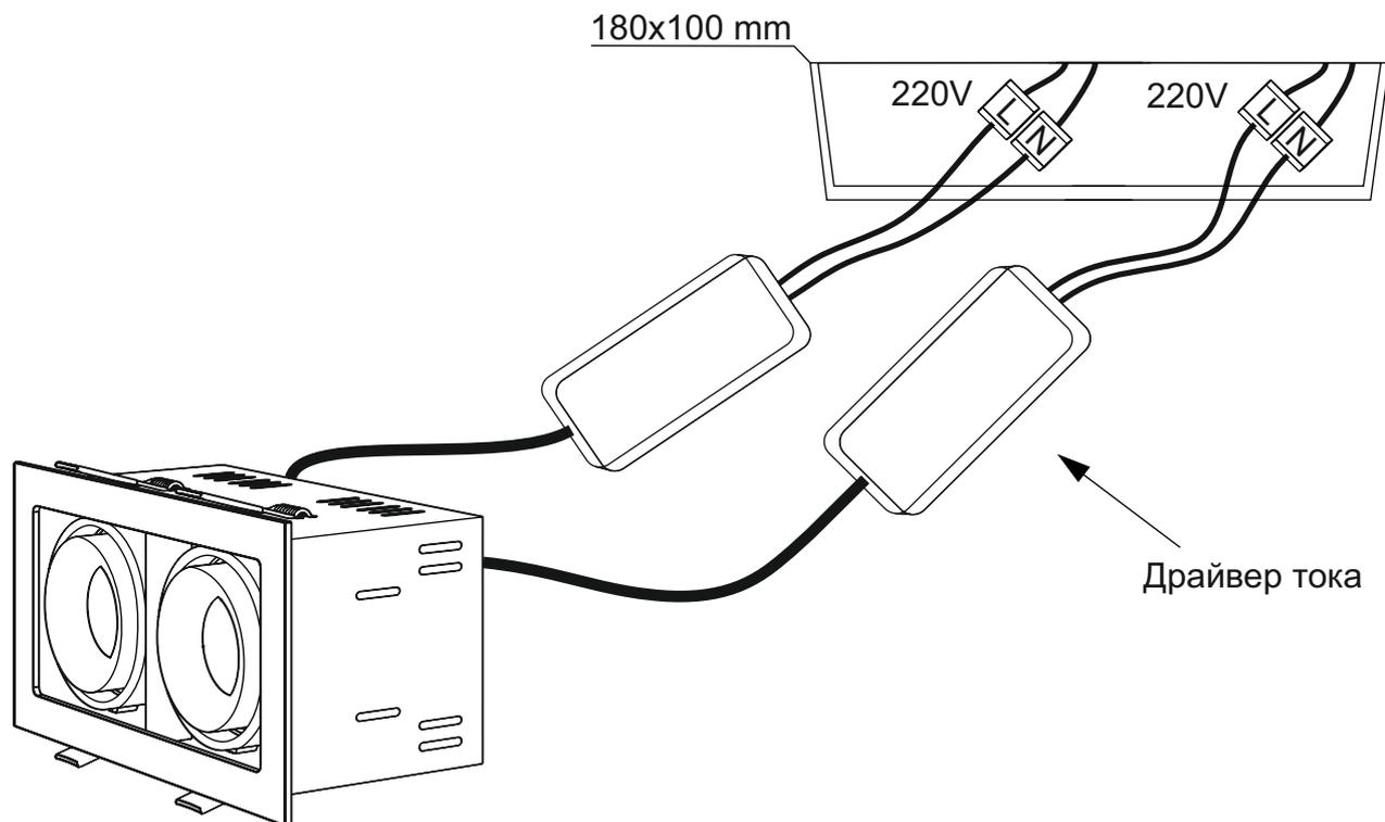
**ВАЖНО:** Установка светильника должна производиться при обесточенной электросети.
